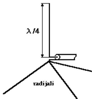
Na UKT-u se najčešće koriste sledeći tipovi antena: YAGI, HB9CV,  $\lambda/2$  (DIPOL),  $\lambda/4$  (VERTIKALKA, GP),  $5\lambda/8$ , JOT, SLIM JIM, SWAN.
